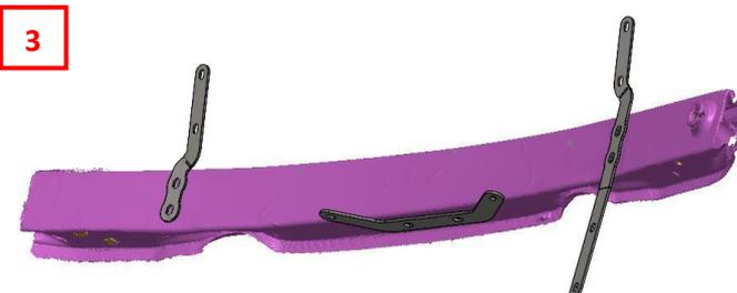
Befestigen Sie den Halter 001002468 auf der Unterseite der Quertraverse, bohren Sie 2x ein 7,5mm Loch und befestigen Sie den Halter mit zwei M8 Gewindefurchende Schrauben.(4;5)
