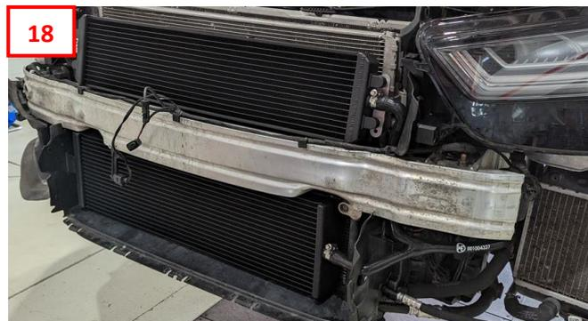
Nach der korrekten Montage der beiden Wasserkühler, prüfen Sie bitte den Kühlmittelstand und füllen Sie ggf. Kühlmittel nach. Achtung: Bitte prüfen Sie den Kühlmittelstand nach der ersten Probefahrt mit abgekühlten Motor anschließend nochmal.
