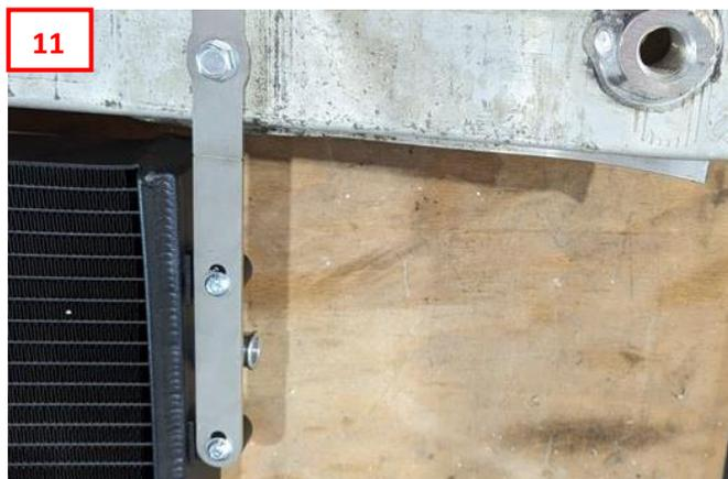
Bearbeiten Sie im nächsten Schritt die Luftführung im Bereich Sensor/Klimakühler.(12)
