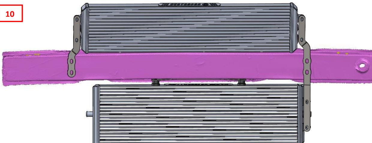
Montieren Sie die beiden Wasserkühler an den vormontierten Haltern mit den Linsenkopfschrauben M6.(10;11) 004001027 unter der Traverse 004001028 über der Traverse
