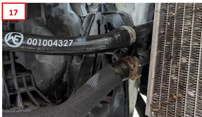
Nach Verlegung der Silikonschläuche kann die Quertraverse mit dem darauf montierten Wasserkühlern wieder am Fahrzeug angebracht werden. Montieren Sie im Anschluss direkt die Silikonschläuche an den beiden Wasserkühlern.(18)
