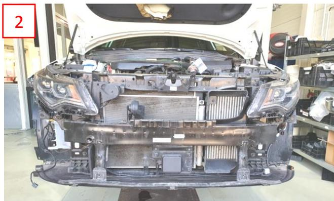
Lösen Sie die Silikonschläuche und die Luftführung und demontieren Sie anschließend den Ladeluftkühler (3 & 4).
