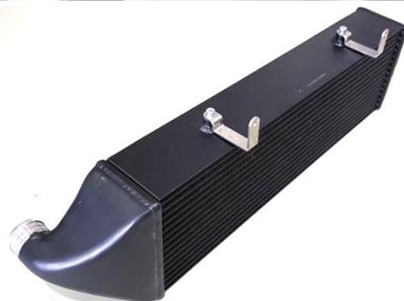
Schließen Sie die Silikonschläuche, den Stecker vom MAP-Sensor und die Druckleitung am WT Ladeluftkühler an.
