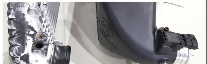
Fixieren Sie den Hilfsrahmen des Kühlerpakets und setzen Sie den WT Ladeluftkühler ein. Befestigen Sie den WT Ladeluftkühler mit den originalen Schrauben an den ursprünglichen Befestigungspunkten.
